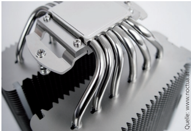
Die Aluminium-Kühlrippen, die Kupfer-Heatpipes und die Kupfer-Bodenplatte dieses CPU-Kühlers sind komplett vernickelt.
