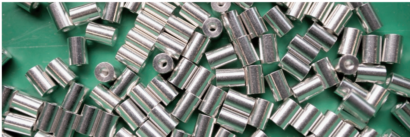
Galvanisch Nickel wird für Verbindungen, Stecker, Kontakte, ... eingesetzt. Konturentreue ist hier nicht massgebend.
