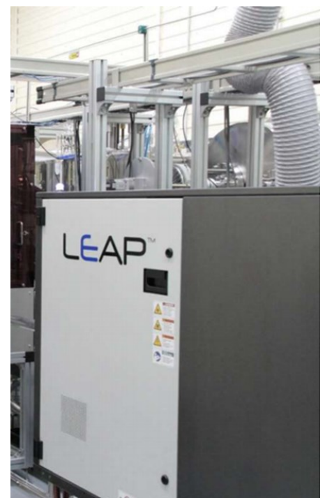
Abb. 2: Seitenansicht des Excimerlasers im Betrieb einer PLD-Beschichtungsanlage.
